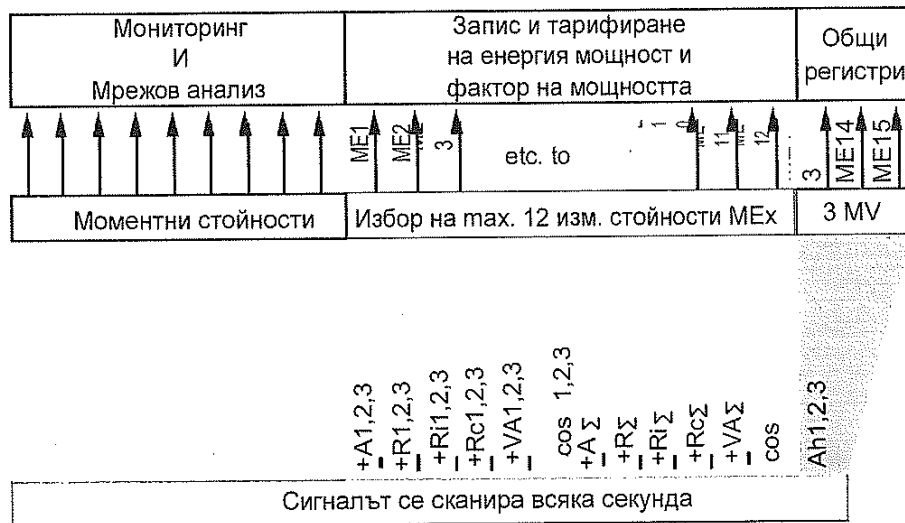
Фиг. 1.11 ZMG310xR – Формиране на измервани стойности На разположение са общо 15 измерващи стойности за допълнителна обработка на енергийните стойности от сумите и отделните фази:
